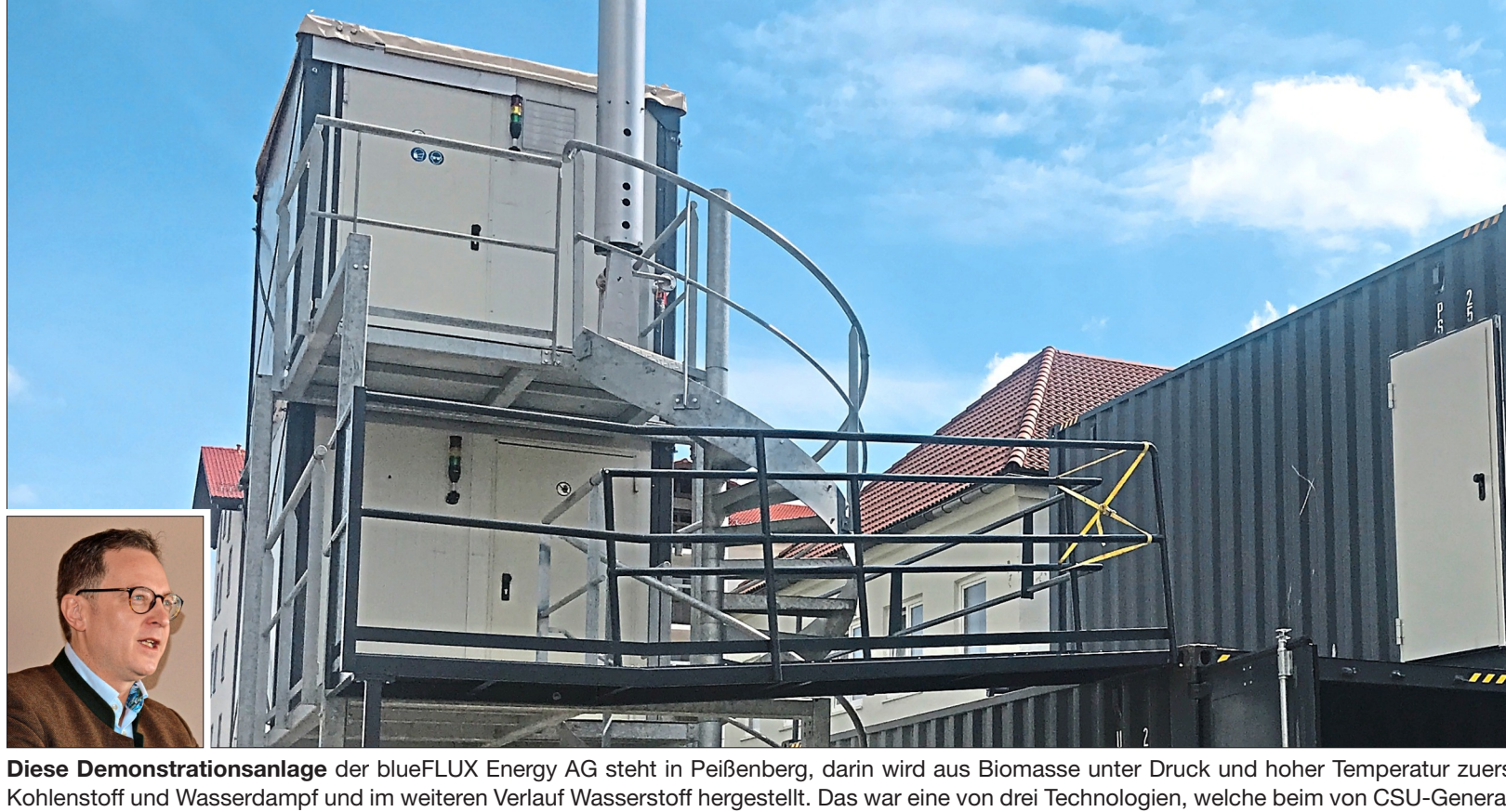
Diese Demonstrationsanlage der blueFLUX Energy AG steht in Peißenberg, darin wird aus Biomasse unter Druck und hoher Temperatur zuerst Kohlenstoff und Wasserdampf und im weiteren Verlauf Wasserstoff hergestellt. Das war eine von drei Technologien, welche beim von CSU-Generalsekretär Martin Huber (kleines Bild) initiierten Wasserstoffgipfel vorgestellt wurden.
